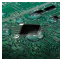
Bộ mạch chống thấm nước (PCB)
